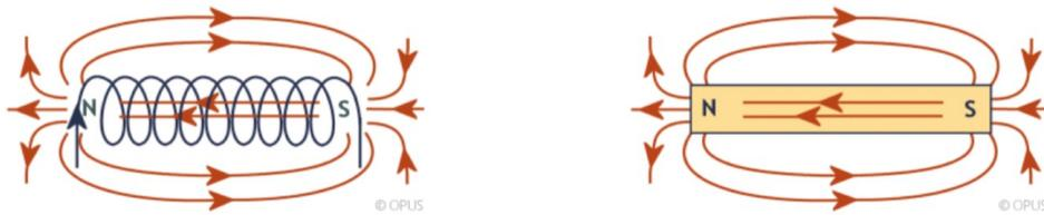
Considérons une spire de rayon  $a$  parcouru par un courant  $I$ . On remarque que le champ produit à grande distance de la spire est comparable à celui produit par un aimant. On parle de dipôle magnétique et on le caractérise par un vecteur appelé moment dipolaire magnétique et orienté Sud-Nord.
