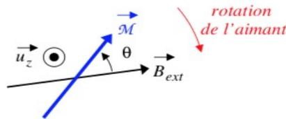
Une boussole comporte une aiguille aimantée qui réagit avec les pôles magnétiques de la Terre. Cette aiguille comporte deux parties : une qui s'aligne sur le nord magnétique et l'autre sur le sud. Souvent, la partie qui indique le nord est rouge. Le nord magnétique ne correspond pas tout à fait au nord géographique qui se trouve plutôt du côté du Canada, au milieu de l'Arctique.
