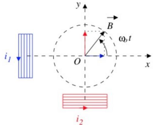
En tout point de son axe, une bobine crée un champ magnétique dirigé selon cet axe et proportionnel à l'intensité du courant. Avec  $i_1(t) = i_0 \cos(\omega_0 t)$  et  $i_2(t) = i_0 \sin(\omega_0 t)$ , on obtient un champ magnétique tournant :
