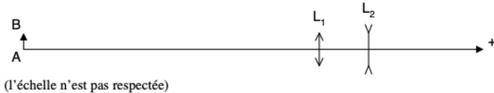
Données numériques :  $h = AB = 0,70 \text{ m}$  ;  $D = O_1A = 50 \text{ m}$  ;  $f_1' = 0,80 \text{ m}$  ;  $f_2' = - 0,08\text{m}$ .
