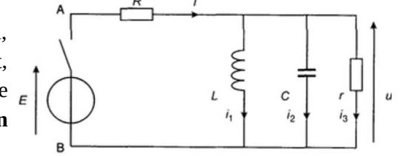
A l'instant  $t = 0$ , l'interrupteur est fermé instantanément et on cherche à déterminer l'évolution ultérieure du réseau électrique.
