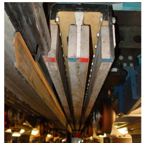
Figure 5 – Supports des aimants permanents situés sous le train
