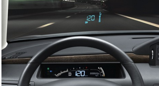
Vue du tableau de bord d'un véhicule muni de l'affichage tête haute
