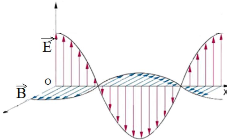
FIGURE 10 – Schéma de la représentation spatiale d'une onde électromagnétique de direction de propagation (Ox)
