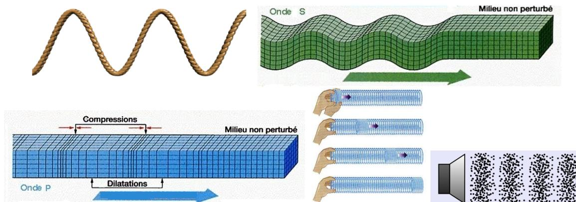
FIGURE 9 – Exemples d'ondes mécaniques
