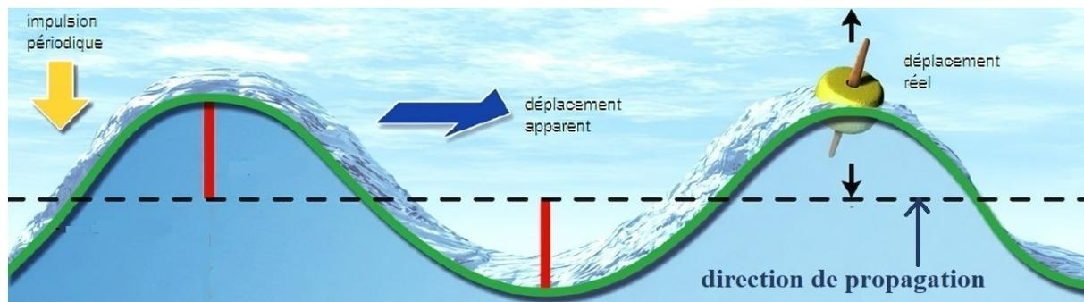
Les vagues schématisées ci-dessus sont caractérisées par la propagation d'un mouvement oscillatoire de la surface de l'eau par rapport à un niveau de référence.
