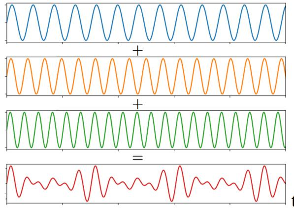
FIGURE 4 – Décomposition d'un signal périodique en somme de signaux sinusoïdaux
