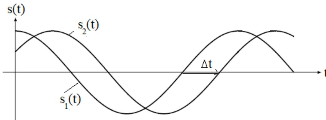
FIGURE 5 – Mise en évidence d'un décalage temporel entre deux signaux sinusoïdaux déphasés
