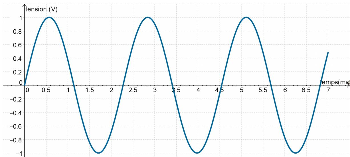
On modélise le signal électrique enregistré par un signal sinusoïdal.
