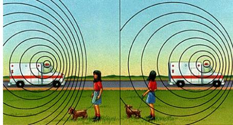
Ce phénomène est connu sous le nom d'**effet Doppler**. Il désigne le décalage de la fréquence d'une onde (mécanique ou électromagnétique) observé entre les mesures lors de l'émission et de la réception, lorsque l'émetteur et le récepteur sont en mouvement relatif.
