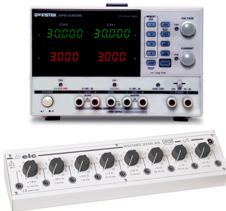
FIGURE 1 – Haut : alimentation stabilisée ; bas : boîte à décades de résistances
