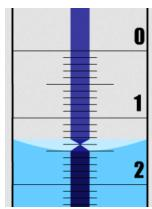
Sur cet exemple, on lit que le volume de solution titrante versé vaut 1,4 mL si on a démarré de la graduation 0 avec la méthode de la double flèche, et 1,5 mL avec la méthode du ménisque. L'écart n'est pas gênant, il suffit de rester cohérent dans la méthode employée du début à la fin de l'expérience.
