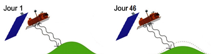
FIGURE 8 – trajets de l'onde émise par le satellite ALOS
