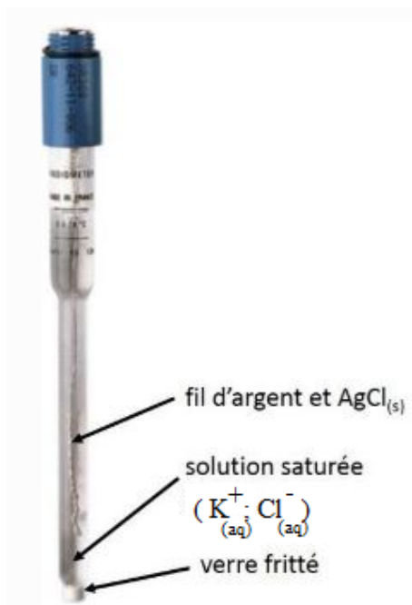
FIGURE 4 – Électrode au chlorure d'argent saturée
