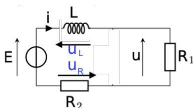
b) Le courant  $i$  traversant une bobine est une fonction continue du temps:
