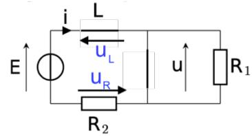
b) La tension  $u$  est la tension aux bornes d'un interrupteur fermé, donc  $u = 0$ .
