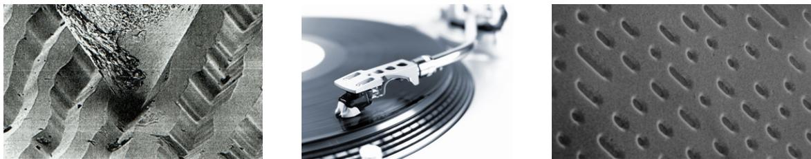
À *Gauche* : Signal analogique gravé dans le sillon vinylique d'un 33 tours. Les mouvements du diamant reproduisent de façon continue les variations temporelles de l'onde sonore enregistrée. À *Droite* : Signal numérique gravé à la surface d'un CD : les variations temporelles de l'onde sonore sont enregistrées de façon discontinue par une suite de nombres, codés en binaire par la présence des creux.
