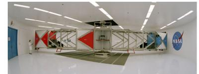
Déterminer l'accélération maximale de la centrifugeuse "20-G" du centre de recherche d'Ames de la Nasa. Le rayon du bras vaut  $R = 8,8$  m et la vitesse angulaire maximale  $\omega_m = 50 \text{ tour} \cdot \text{min}^{-1}$ .
