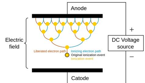
On souhaite étudier le mouvement d'un électron de masse  $m = 9,1 \cdot 10^{-31}$  kg et de charge  $-e = -1,6 \cdot 10^{-19}$  C entre deux chocs avec une molécule. À cet effet, on considère une géométrie simple en plaçant un gaz entre deux électrodes parallèles métalliques, séparées d'une distance  $D$  et reliées à un générateur de tension  $U$ . On note  $(Ox)$  l'axe reliant les deux électrodes.
