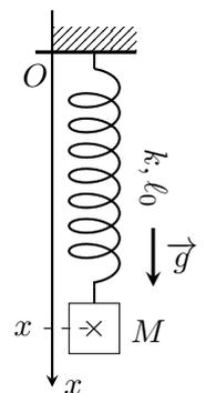
1. Effectuer le bilan des forces et déterminer la position d'équilibre  $x_{\text{eq}}$  à l'aide du PFD à l'équilibre. Évaluer la raideur  $k$  d'un amortisseur de voiture de masse  $m = 1 \text{ tonne}$  pour un allongement  $\Delta\ell = 10 \text{ cm}$ .
