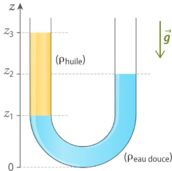
Déterminer la masse volumique de l'huile en fonction de la masse volumique de l'eau douce et de  $z_1$ ,  $z_2$ ,  $z_3$ .
