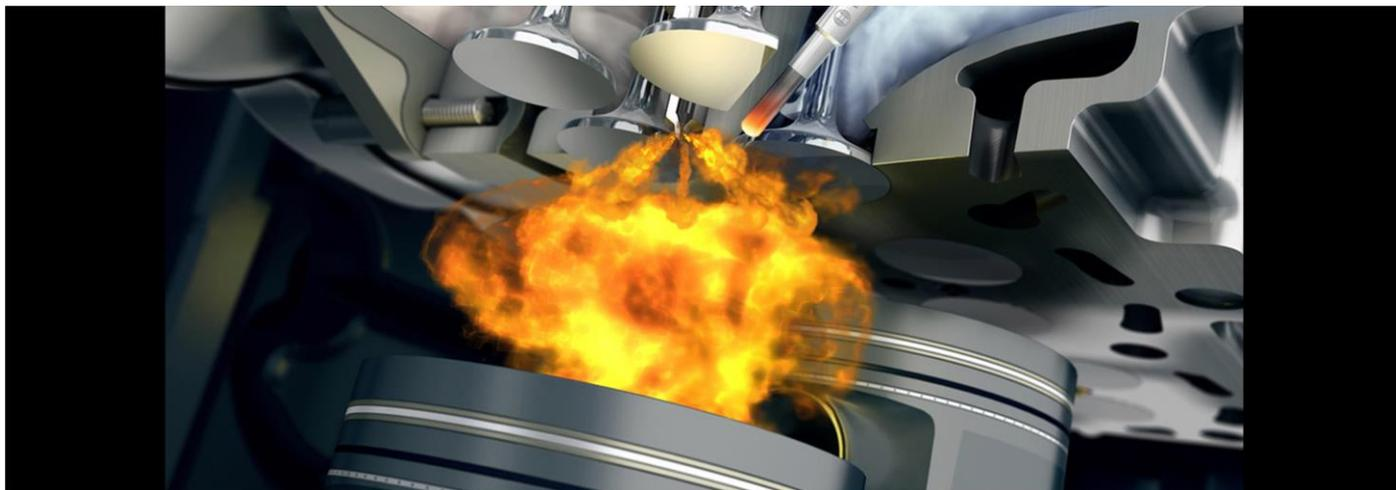
Combustion du mélange air-essence dans un moteur thermique
