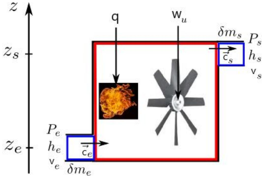
Le fluide traverse à présent un élément de machine dans lequel il reçoit du travail et/ou du transfert thermique.
