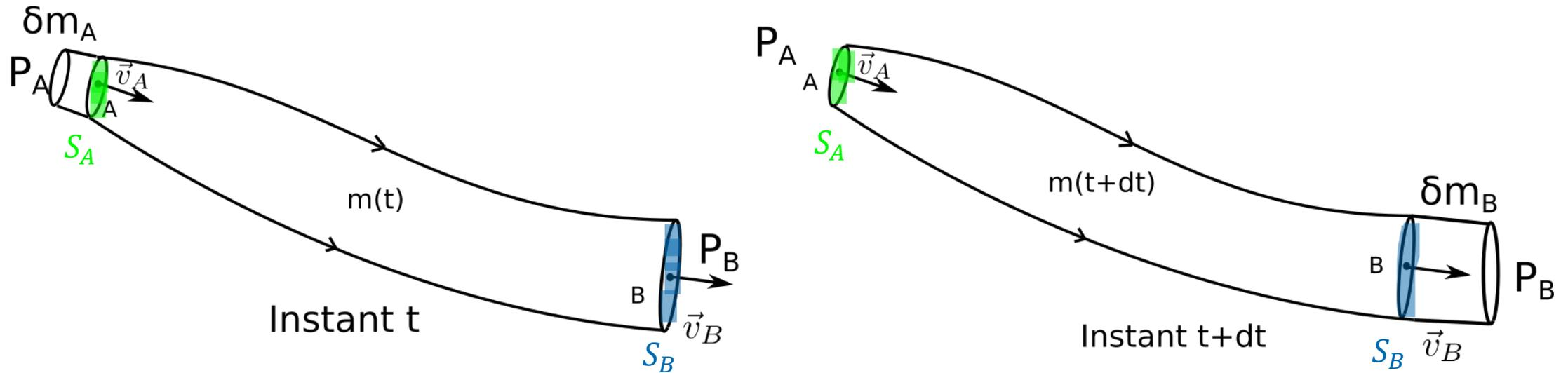
On considère un écoulement parfait, stationnaire, incompressible et homogène de masse volumique  $\rho$ , dans un tube de courant délimité par les sections fixes  $S_A$  et  $S_B$ .
