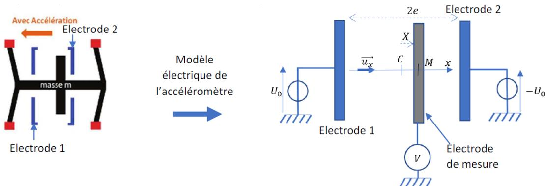
La masse  $m$  en translation, toujours repérée par le point  $M$ , est maintenant assimilée à une électrode mobile dans  $R$  permettant de mesurer le potentiel électrique (on admettra que la présence de cette électrode mobile ne perturbe pas le champ électrique créé par les électrodes 1 et 2).
