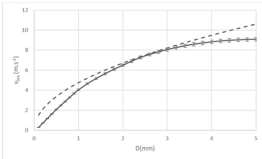
FIGURE 1 – Influence du diamètre des gouttes sur la vitesse limite.
