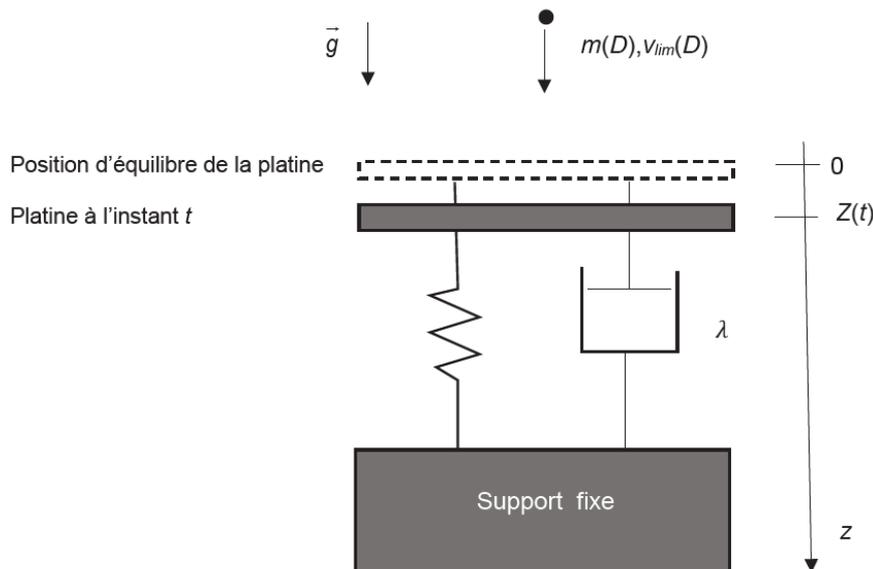
FIGURE 3 – Modélisation du disdromètre à impact à platine.
