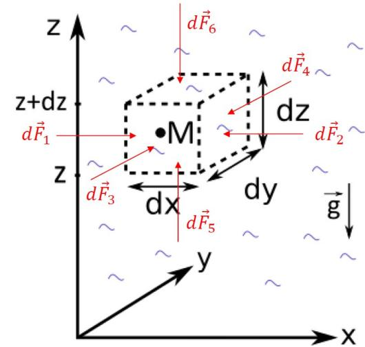
Figure 2 – Bilan des forces sur une particule fluide
