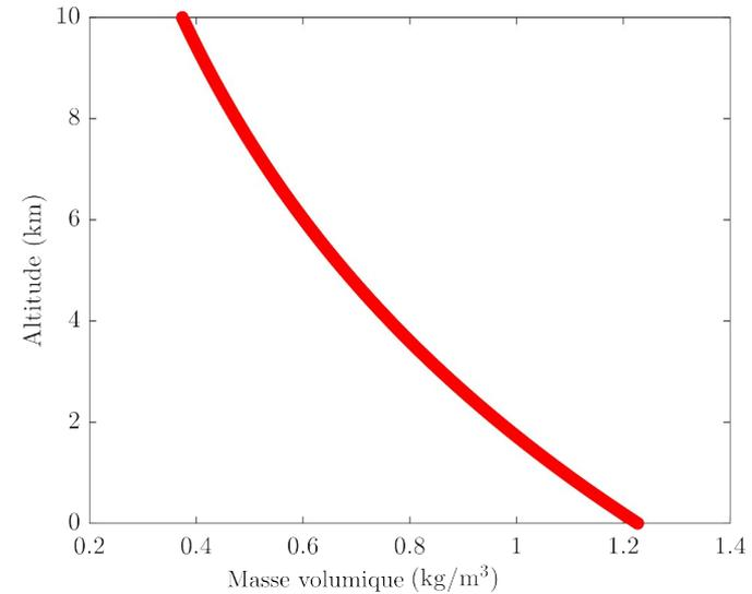
Figure 4 – Profils verticaux de pression et densité dans l'atmosphère
