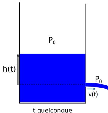
FIGURE 4 – Schéma de la vidange de Torricelli
