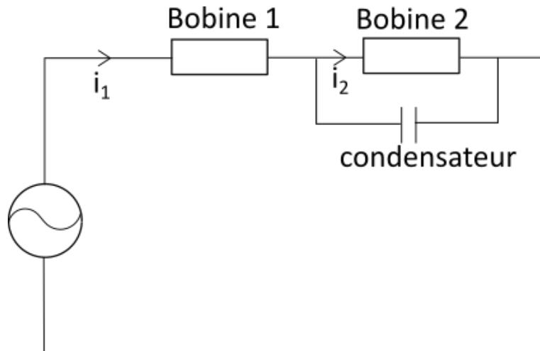
**Attention à ne pas laisser longtemps sous tension, car les condensateurs chauffent et peuvent se détériorer.**
