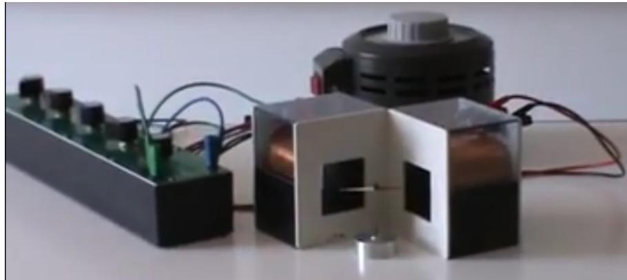
Pour créer un champ magnétique tournant, les deux bobines doivent être alimentées avec des courants ayant un déphasage entre eux de  $\pi/2$ . Le circuit suivant est envisagé :
