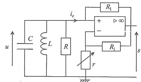
5. Présentation et démonstration de la condition d'oscillation dans le domaine fréquentiel (condition de Barkhausen)
