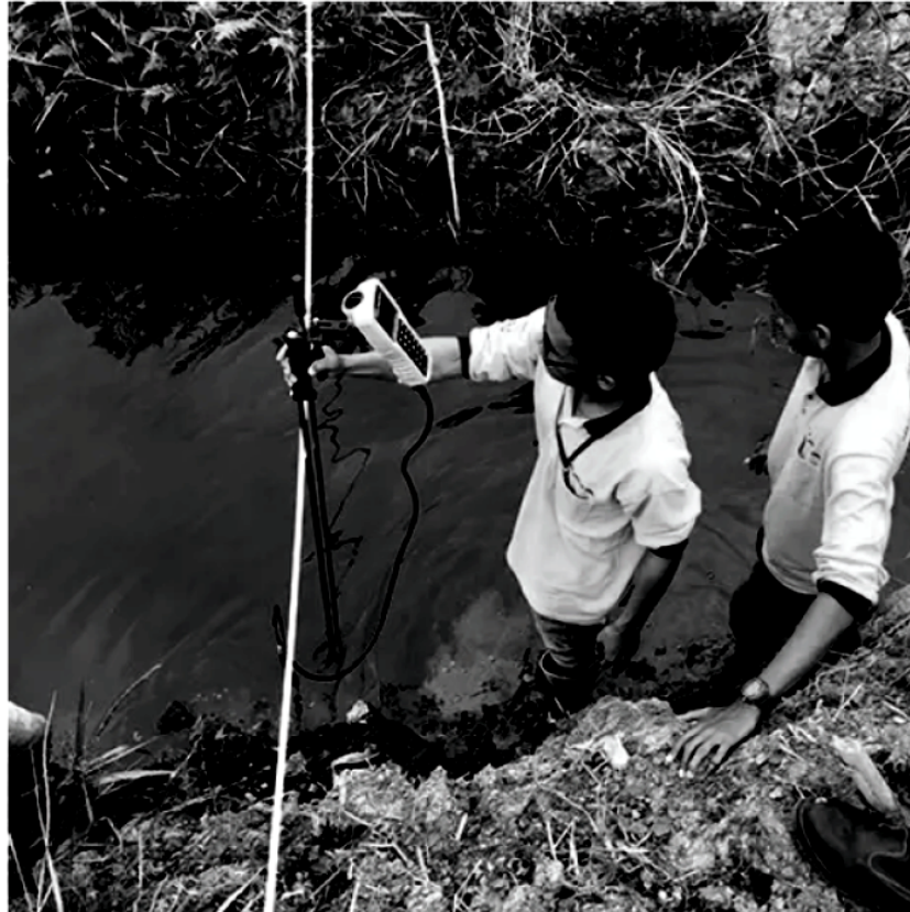
Photo 1 - Mesure de la vitesse d'écoulement d'une rivière par sonde à effet Doppler
