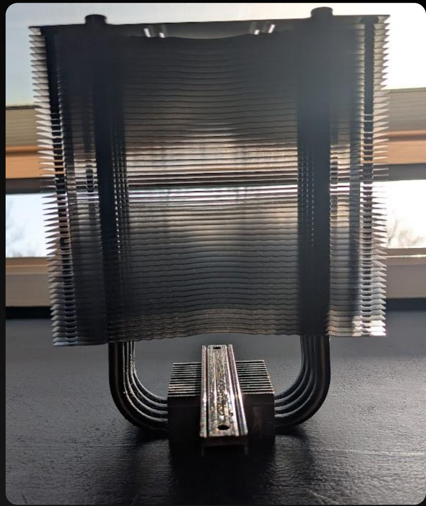
Photographie d'un radiateur avec ses ailettes de refroidissement
