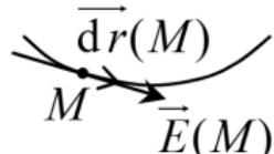
On obtient l'équation d'une ligne de champ en écrivant que le champ en un point  $M$   $\vec{E}$  est tangent à l'élément de longueur orientée  $d\vec{r}(M)$  de la ligne de champ en ce point, soit
