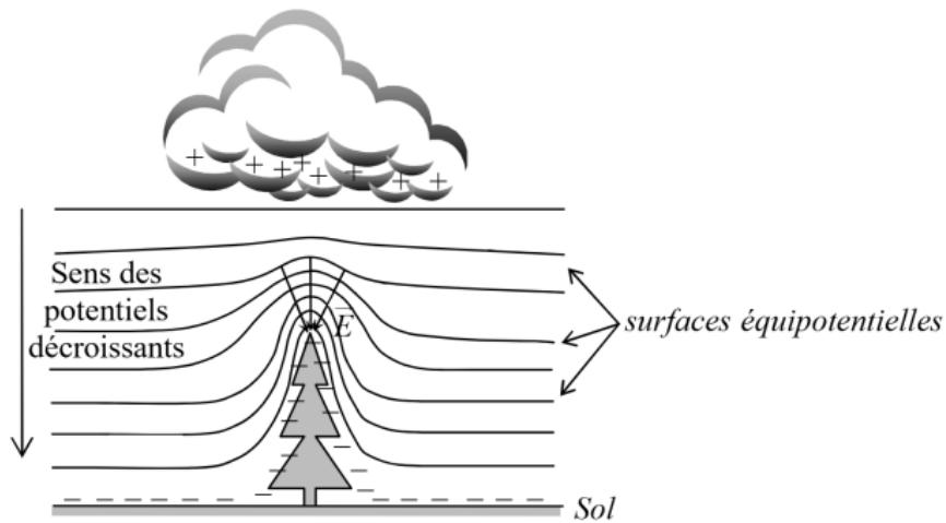
On constate que le champ électrique est plus intense au niveau des pointes, c'est ce qu'on nomme l'effet de pointe. Si le champ est assez intense, il peut alors ioniser l'air qui devient conducteur, un courant peut alors passer pour équilibrer les charges électriques entre le sol et le ciel : c'est la foudre.
