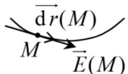
On obtient l'équation d'une ligne de champ en écrivant que le champ en un point  $M$   $\vec{E}$  est tangent à l'élément de longueur orientée  $d\vec{r}(M)$  de la ligne de champ en ce point, soit
