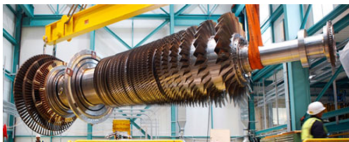
Turbine d'une centrale à gaz.
