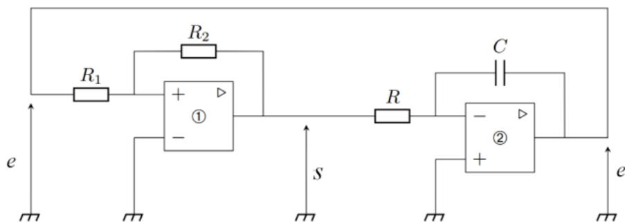
Sur le bloc de gauche, comparateur à hystérésis non inverseur :
