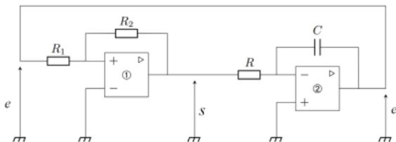
L'instant de basculement correspond à l'instant  $t_2$  pour lequel  $e(t_2) = \beta V_{sat}$ , soit
