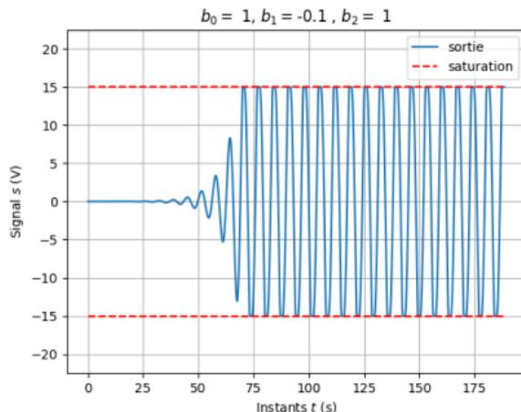
le signal sinusoïdal s'accroît progressivement jusqu'à ce que les non linéarités stoppent l'accroissement et bornent l'amplitude aux valeurs de saturation.
