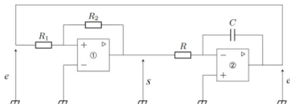
Imaginons qu'on bascule en saturation haute dans le bloc de gauche à  $t = 0$  (on peut faire la même étude avec la saturation basse). Dans ce cas  $e(t_0) = \beta V_{sat}$  et  $s(t) = +V_{sat}$  et on peut obtenir la valeur de  $e$  en sortie du bloc de droite :
