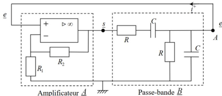
La condition de Barkhausen appliquée à l'oscillateur à pont de Wien implique qu'il y aura oscillations spontanées si l'amplification  $A = 3$ . Ces oscillations oscilleront à une pulsation  $\omega$  égale à la pulsation de coupure du filtre passe-bande  $\omega_0 = \frac{1}{RC}$ .
