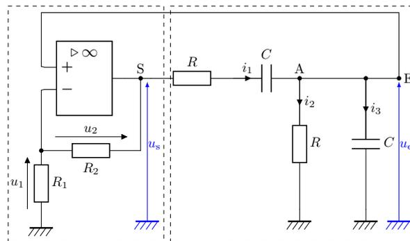
b) Le pont diviseur de tension du cadre de gauche permet d’écrire une relation entre  $u_1$  et  $u_s$ .
