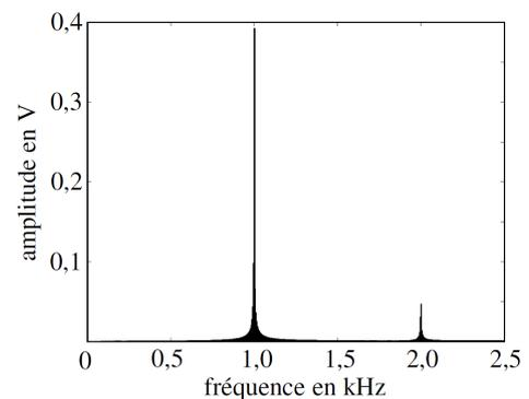
1. Un signal triangulaire est composé d'harmoniques de rang impair, soit le fondamental de fréquence  $f = 1$  kHz,  $3f = 3$  kHz,  $5f = 5$  kHz, etc. Pour l'harmonique de rang 3 la fréquence d'échantillonnage ne respecte pas le critère de Nyquist-Shannon
