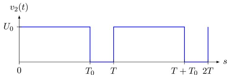
5. Le signal  $v_2(t)$  a une période de  $T$  (le motif se répète tous les  $T$ ). Durant une durée  $T_0$  le signal a une valeur  $U_0$  et pendant la durée  $T - T_0$  il a une valeur nulle, la moyenne du signal est donc
