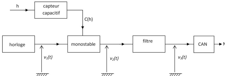
Un monostable est un circuit possédant deux états en sortie. Un état stable (durée indéfinie) et un état instable de durée  $T_0$  fixe. Le passage à l'état instable se produit sous l'effet d'une impulsion de commande délivrée par le signal d'horloge de période  $T = 2,00$  ms et dont l'état haut a une durée  $\theta$  très petite devant  $T$  (voir document ci-après). On impose  $T_0 < T$ .
