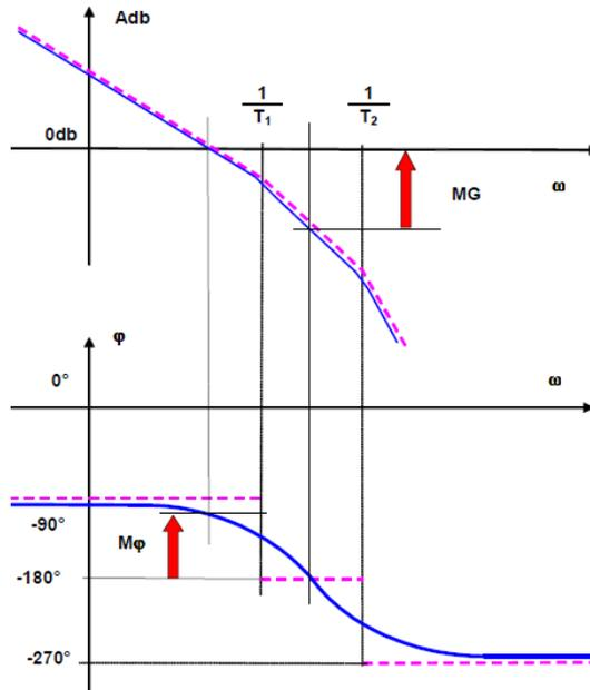
L'intégration placée après la perturbation ne permet pas d'obtenir un système précis. On décide donc d'utiliser un correcteur proportionnel et intégral, de fonction de transfert  $C(p) = K_p \left(1 + \frac{1}{T_i p}\right)$
