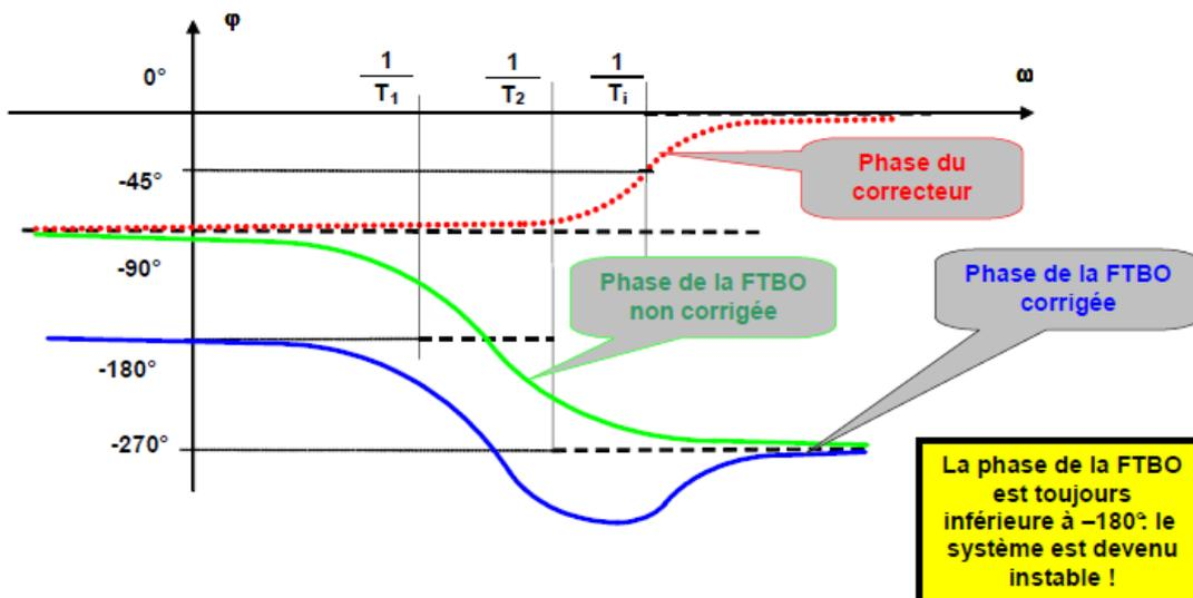
**Choix pertinent de la constante  $T_i$ :** Si la constante de temps  $T_i$  est plus grande que les deux constantes  $T_1$  et  $T_2$ , alors on préserve pour la phase de la FTBO corrigée une gamme de pulsations où elle sera supérieure à  $-180^\circ$ . Le système pourra alors rester stable si par ailleurs on choisit convenablement la valeur de  $K_p$ .
