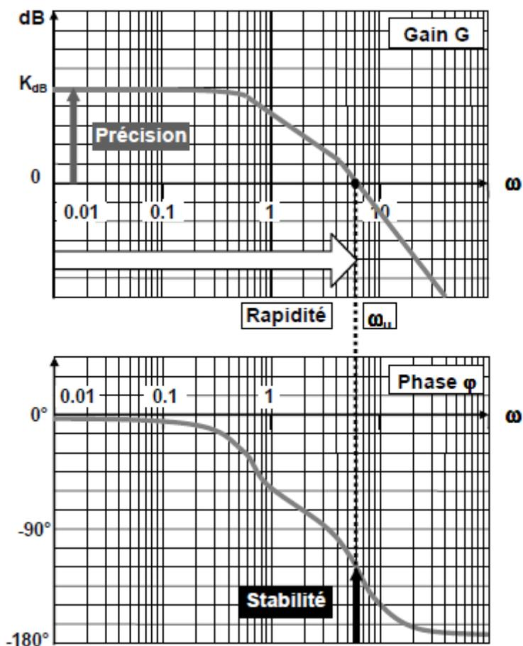
La **stabilité** est liée aux caractéristiques de la FTBO au voisinage de  $\omega_{0dB}$ .
