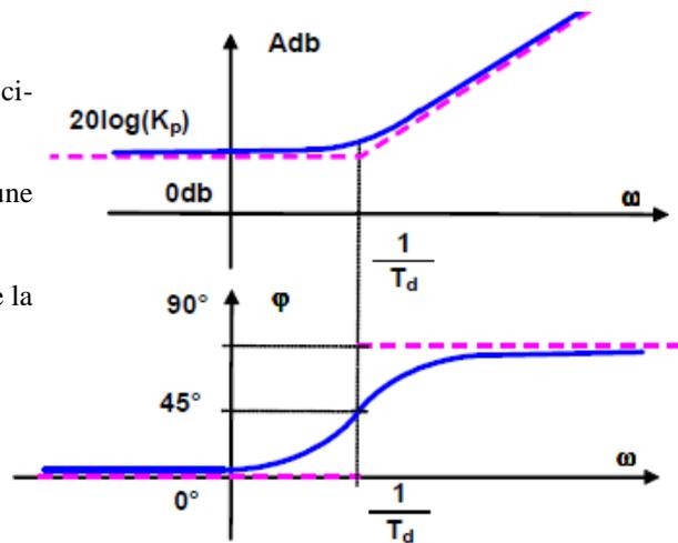
On utilise en réalité des correcteurs dont la fonction de transfert est de la forme suivante :
