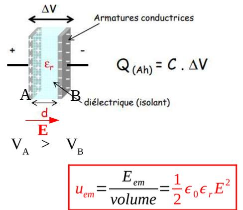
On souhaite réaliser un condensateur avec un diélectrique composé de polypropylène de permittivité relative  $\epsilon_r = 2,2$  afin d'éviter un claquage (destruction de l'isolant suite à l'application d'un champ électrique trop important) on se restreint à un champ électrique de  $E_{max} = 70 \text{ MVm}^{-1}$
