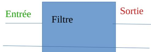
$$\underline{H} = \frac{v_s}{v_e}, \text{ Gain en décibels (dB)} \quad \underline{G_{dB}} = 20 \log |\underline{H}| \quad \underline{arg(\underline{H})} = \varphi_s - \varphi_e$$
