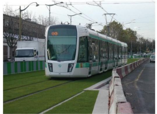
Tramway de la ligne T3, ici sur une section avec ligne aérienne de contact.
