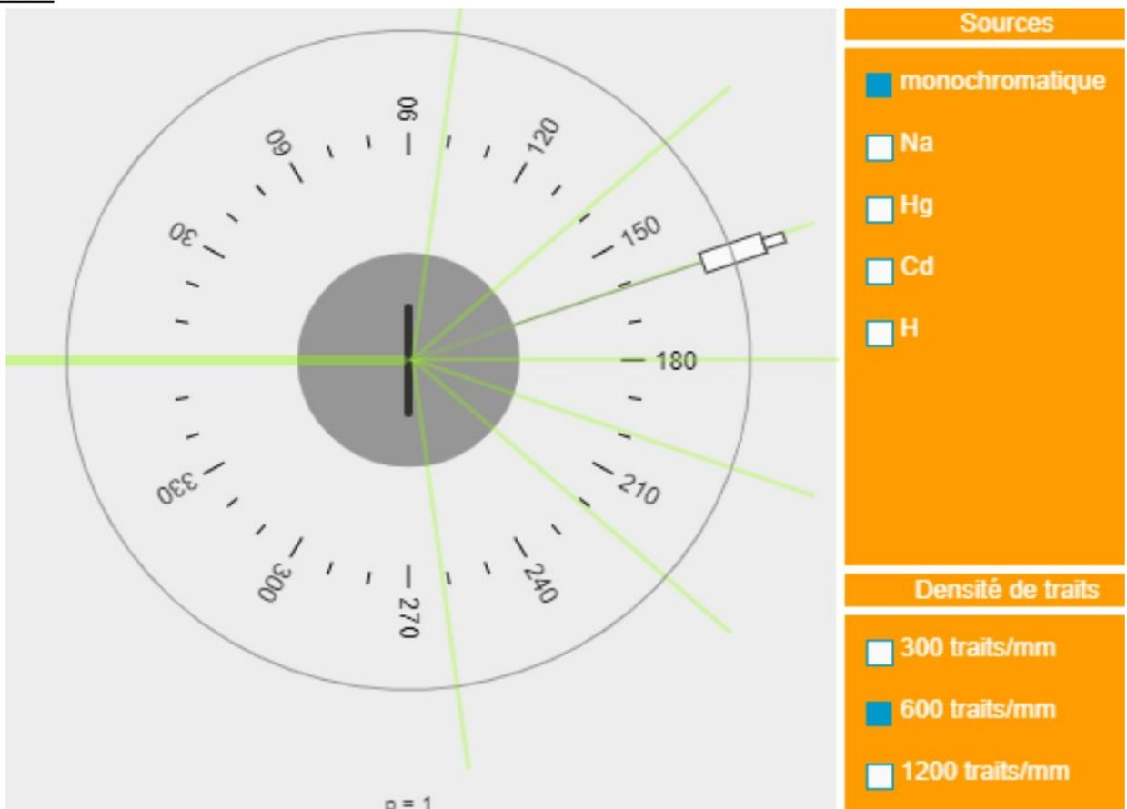
Le faisceau se démultiplie à la sortie du réseau
