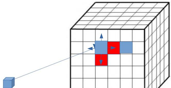
$$\iiint_{V \text{ enveloppé par } S} \text{div}(\vec{U}) d\tau = \int d\phi = \oiint_S \vec{U} \cdot d\vec{S}$$
