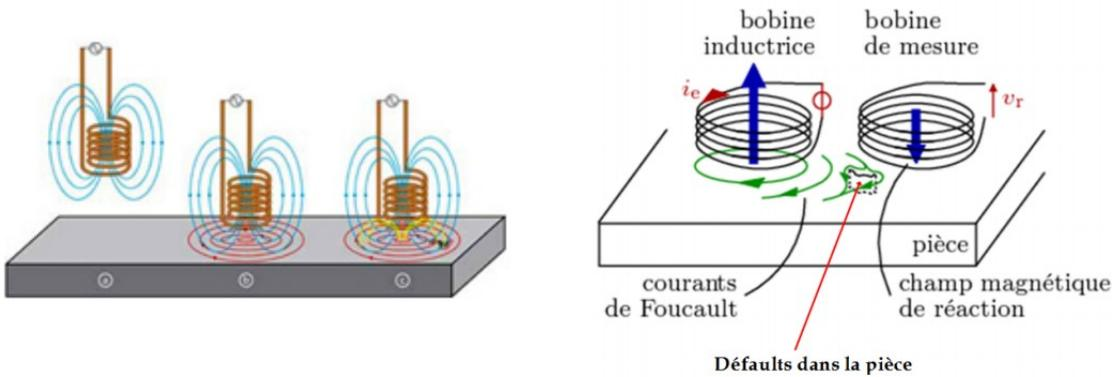
La variation du champ magnétique dans le matériau conducteur entraîne l'apparition de courants électriques dit courants de Foucault.
