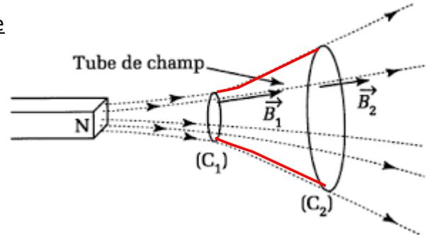
$$B_2 S_2 - B_1 S_1 = 0 \quad B_1 > B_2$$
