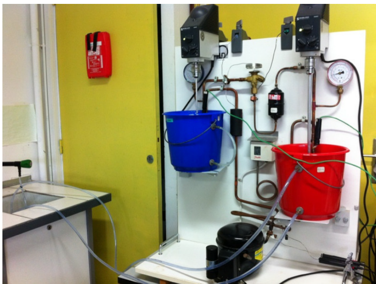
Figure : Pompe à chaleur avec dispositif de refroidissement
