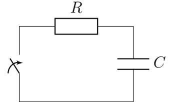
R1. (voir § II.3) Établir l'équation différentielle vérifiée par la tension aux bornes du condensateur.
