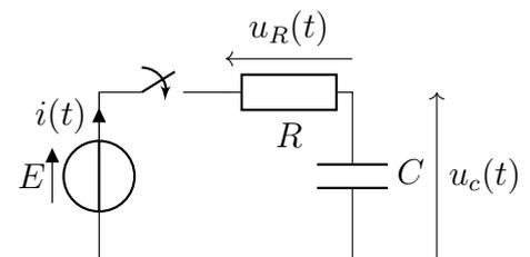
R1. (voir § II.3) Établir l'équation différentielle vérifiée par la tension aux bornes du condensateur.
