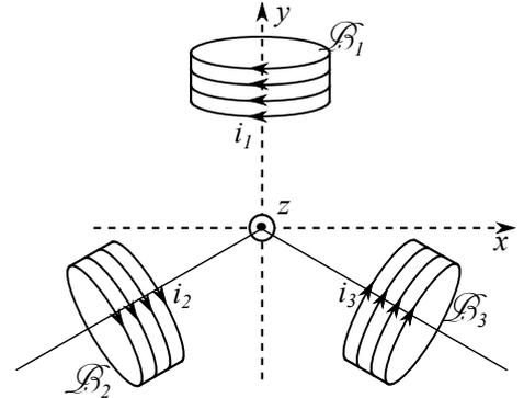
Le champ magnétique créé par la bobine  $j$  s'écrit  $\vec{B}_j = \pm K i_j \vec{u}_j$ , avec  $\vec{u}_j$  est le vecteur unitaire de l'axe de la bobine. Le signe sera choisi par règle de la main droite. La constante  $K$  est identique pour les trois bobines.
