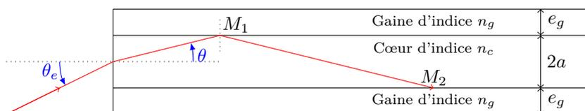
Un cylindre d'indice  $n_c$  et de rayon  $a$ , dénommé cœur de la fibre, est entouré d'un milieu d'indice  $n_g$  plus faible ( $n_c > n_g$ ) d'épaisseur  $e_g$ , dénommé gaine de la fibre. La fibre est placée dans l'air d'indice égal à  $n_0$ .
