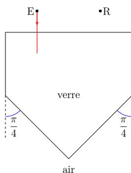
L'émetteur (E) est un faisceau laser et le récepteur (R) est une photodiode. Cette dernière fournit un signal électrique lorsqu'elle reçoit de la puissance lumineuse. L'indice du verre est pris ici à  $n_{\text{verre}} = 1,5$  et celui de l'air  $n_{\text{air}} = 1,0$ .
