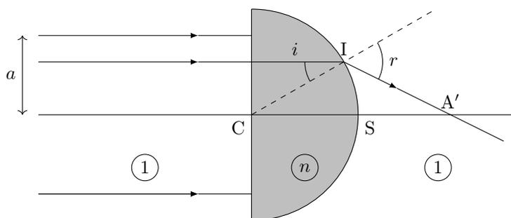
1. Un rayon donné de ce faisceau émerge en coupant l'axe optique en un point  $A'$ . Établir la relation donnant  $CA'$  en fonction de  $R = CS$  et des angles  $i$  et  $r$ .
