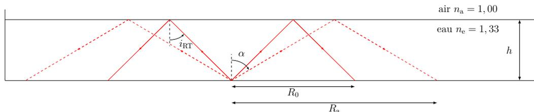
On tient compte du phénomène de réflexion totale du rayon issu de la lampe vers l'interface eau-air.  $i_{RT}$  est l'angle limite de réflexion totale pour un rayon lumineux se propageant de l'eau vers l'air.
