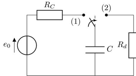
Nous noterons  $u(t)$  la tension à l'instant  $t$  aux bornes du condensateur. Lors de l'étape de charge, l'interrupteur  $K$  est en position (1) : le condensateur de capacité  $C = 20$  mF est alimenté par une pile de f.é.m  $e_0 = 12$  V et de résistance interne  $R_C = 50$   $\Omega$ . Lors de la décharge (flash), l'interrupteur bascule en position (2) et alimente la lampe, assimilée à un conducteur ohmique de résistance  $R_d = 0,50$   $\Omega$ .
