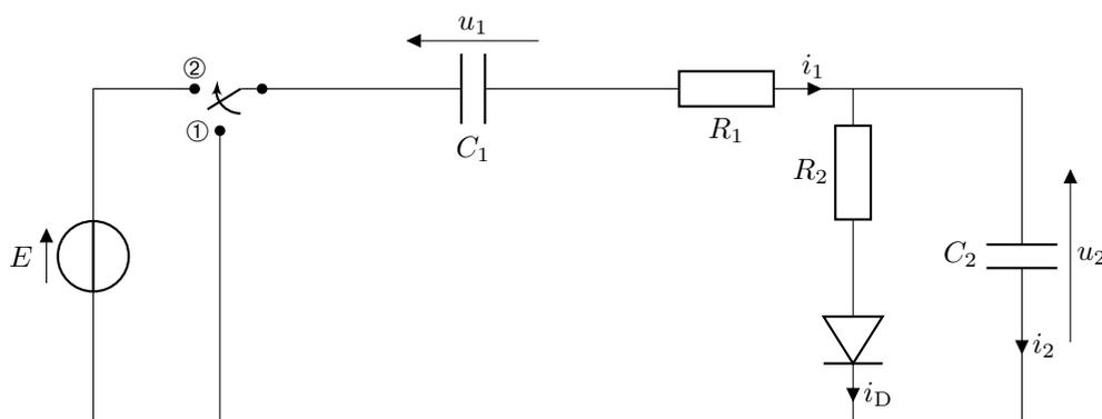
5. 1.  $i_1 = \frac{E}{R_1}$  2.  $u_1 = E$  et  $u_2 = 0$  3.  $i_1 = -\frac{E}{R_1}$  puis montrer que la diode est bloquée pendant la charge en déterminant l'équation différentielle vérifiée par l'intensité qui traverse cette diode dans le cas passant.  $u_1 = -u_2 = \frac{C_1 E}{C_1 + C_2}$ .
