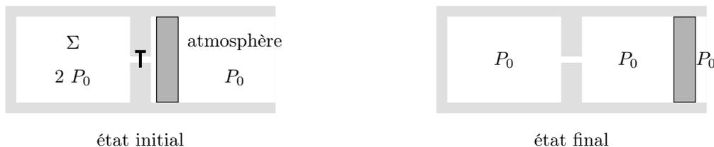
$$\text{Calculons le travail reçu par le gaz : } W(1 \rightarrow 2) = \int_{V_1}^{V_2} -P_{\text{ext}} dV = -P_0 (V_2 - V_1) = P_0 V_1 - P_0 V_2 = nR \left( \frac{T_1}{2} - T_2 \right).$$
