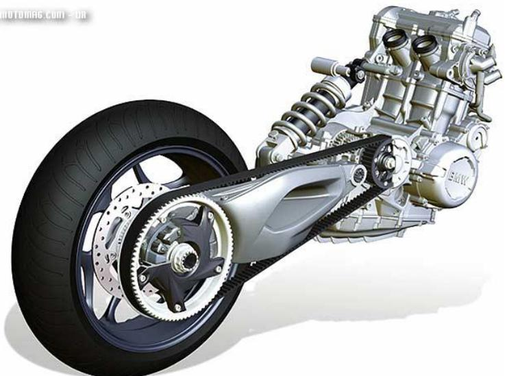
Transmission par courroie crantée d'une moto
