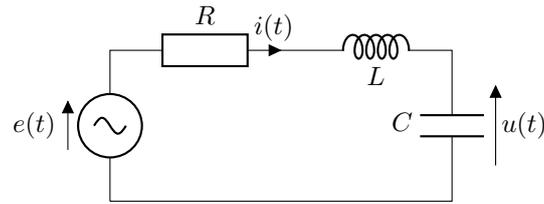
**Q.1** On introduit la charge  $q(t)$  du condensateur  $C$  telle que  $i(t) = \frac{dq}{dt}$ . Écrire l'équation traduisant la loi des mailles dans le circuit et faisant intervenir  $e(t)$ ,  $i(t)$  et  $q(t)$ .
