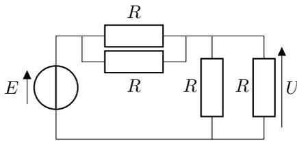
Q.2 Calculer  $i$  dans le montage suivant :
