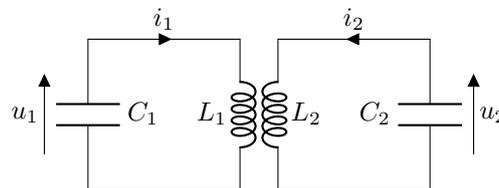
**Q.1** Soit  $q_1$  et  $q_2$  les charges des condensateurs à l'instant  $t$ , établir le système d'équations différentielles vérifié par  $q_1$  et  $q_2$ . On posera  $k = \frac{M}{L} \leq 1$  et  $\omega_0 = \frac{1}{\sqrt{LC}}$ .
