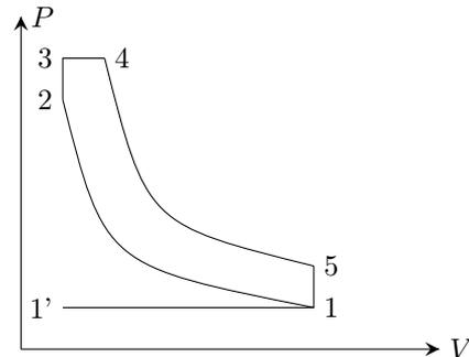
Au point 1 du cycle, la pression  $P_m = 1,0 \text{ bar}$  et la température  $T_m = 293 \text{ K}$  sont minimales. La pression maximale, aux points 3 et 4 vaut  $P_M = 60 \text{ bar}$  et la température maximale, au point 4, vaut  $T_M = 2073 \text{ K}$ . Le rapport volumétrique de compression vaut  $\beta = \frac{V_M}{V_m} = 17$ .
