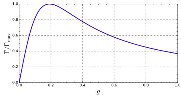
Couple moteur en fonction du glissement  $g = \frac{\omega_g}{\omega_s}$
