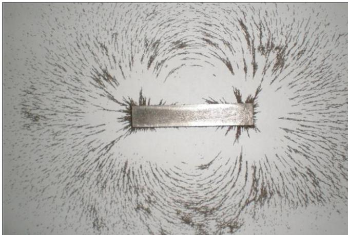
Ainsi, l'aimant semble avoir une action sur les petits barreaux ou sur les grains de limaille de fer : l'aimant doit exercer des forces qui orientent chaque élément de différentes façons suivant l'endroit, le point de l'espace où se trouve cet élément.
