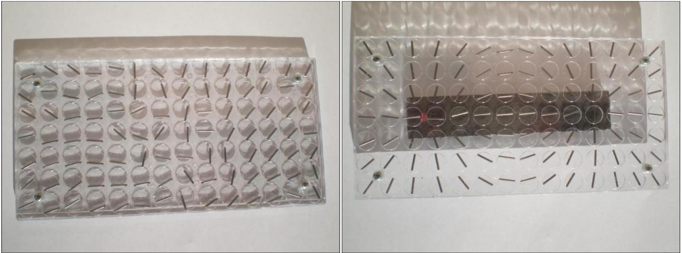
On place maintenant un aimant droit sous le support contenant les barreaux (photo de droite) ; ceux-ci s'orientent différemment : il semble se dessiner une figure que l'on appelle **spectre magnétique** de l'aimant droit.
