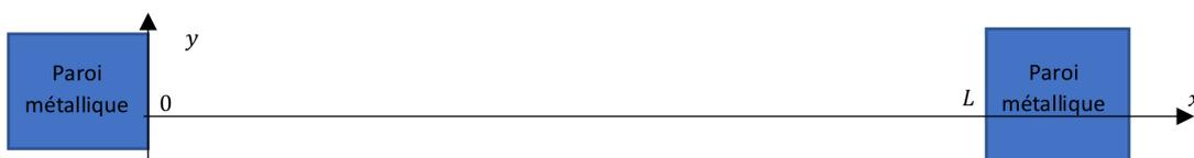
Le magnétron présent dans le micro-ondes va générer un champ électromagnétique de fréquence  $f \simeq 2,5$  GHz (cette fréquence a été choisie pour avoir un bon compromis entre la pénétration du champ dans les aliments et sa dissipation sous forme thermique par interaction avec les molécules d'eau). Pour ce modèle simple, le champ électrique qui s'établit dans la cavité est tel que  $\vec{E}(M, t) = E(x, t)\vec{u}_y$ . On montre que ce champ électrique vérifie :
