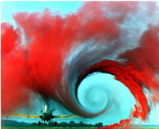
FIGURE 1 – Vortex formé par une aile d'avion.
