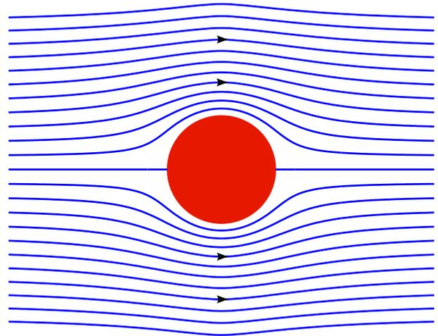
FIGURE 10 – Écoulement irrotationnel autour d'un cylindre.
